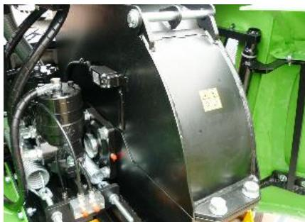
L'espace d'une partie du disque broyeur est basculante, assurée par un interrupteur de fin de course, fixée par deux vis. En cas de son ouverture partielle, le moteur à combustion pour l'entraînement du broyeur ne peut pas se mettre en marche. Les vis doivent être bien serrées.
