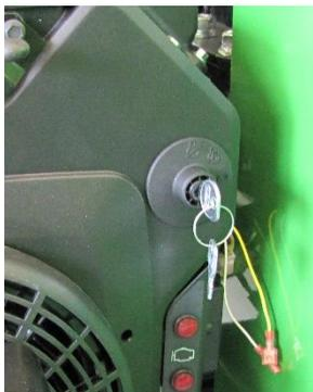
**La boîte de contrôle assure l'alimentation et la commande du circuit de sécurité et du moteur à combustion.**
