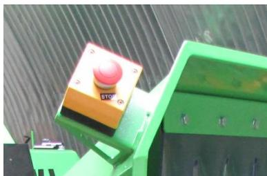
**Le bouton d'arrêt d'urgence** - après avoir appuyé sur le bouton, le moteur à combustion et toute la machine s'arrêtent. Pour désactiver les boutons doit être tourner les têtes dans la direction de la flèche.
