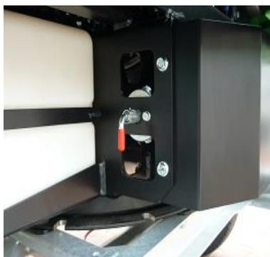
Le répartiteur est utilisé pour le raccordement de la batterie avant de mettre la machine en fonctionnement. Le sectionneur est situé sur le boîtier de la batterie
