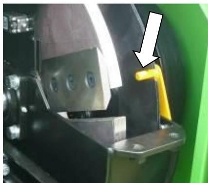
Le pivot de blocage du rotor du dispositif broyeur sert à arrêter le moteur pendant un entretien ou un remplacement de lames etc.
