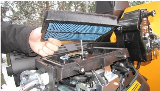
Insert en mousse et insert filtrant en papier
