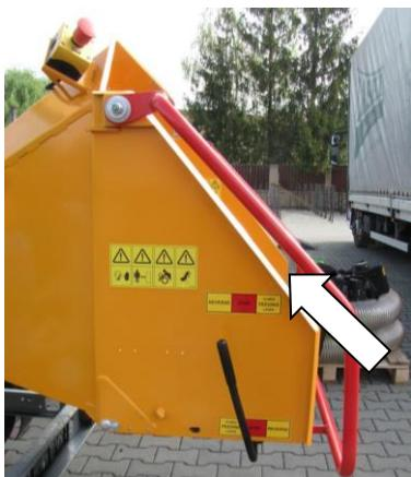
Le cadre de sécurité pour l'insertion des matériaux sert d'une commande de marche du cylindre d'insertion et de son arrêt. Si l'opérateur pèse sur le cadre en cas d'un accrochage d'une personne par des matériaux broyés, ou en cas d'une autre nécessité, le broyeur s'arrête tout de suite.
