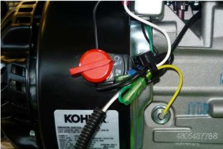
L'interrupteur de la marche du moteur est pivotant, à deux positions: marche – arrêt.
