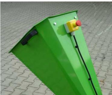
Le bouton d'urgence du débranchement de la goulotte de remplissage permet instantanément d'éteindre le moteur en marche. Attention rotor continue à tourner.
