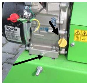
bouchon de vidange et de remplissage avec l'indicateur du niveau d'huile de moteur
