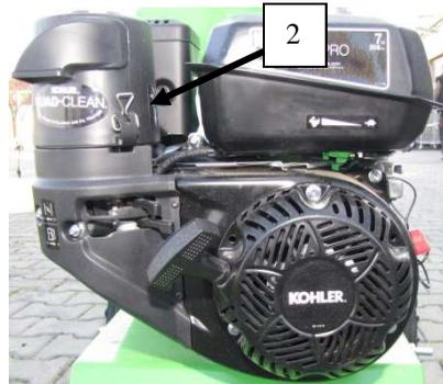
épurateur de l'air, une chemise à fonction centrifuge des impuretés et la cartouche sèche (2) au-dessous du capot
