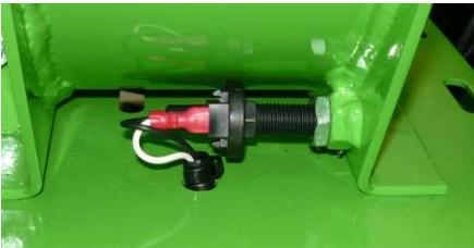
L'accès au couteau – à l'espace de broyage. Il protège contre un basculement indésirable du couvercle de l'espace de broyage.
