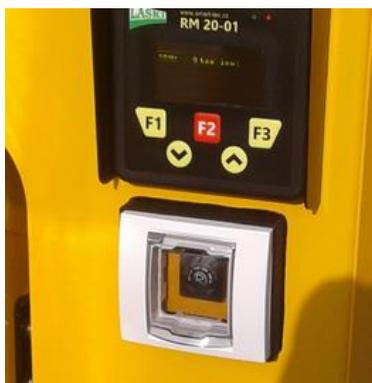
Bouton de **commutateur de carburant (sous le bouchon)**. Appuyer sur le bouton définitivement l'opération à l'essence
