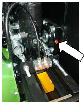
Graisseur du palier du disque broyeur.
