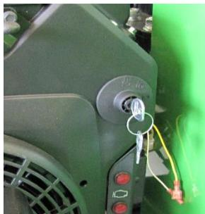
**La boîte de contrôle assure l'alimentation et la commande du circuit de sécurité et du moteur à combustion.**
