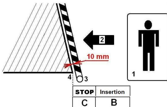
légende : 1 – position de l'opérateur, 2 – direction de l'insertion des matériaux à broyer, 3 – cadre de protection, 4 – bord de l'auge d'insertion, B – position du cadre de sécurité à l'insertion, C – position du cadre de sécurité STOP
