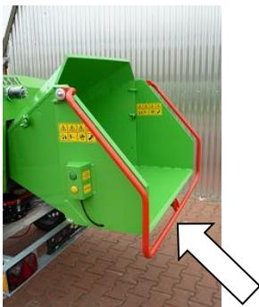
Le cadre de sécurité pour l'insertion des matériaux sert d'une commande de la marche du cylindre d'insertion et de son arrêt. Si l'opérateur pèse sur le cadre en cas d'un accrochage d'une personne par des matériaux broyés, ou en cas d'une autre nécessité, le broyeur s'arrête tout de suite.
