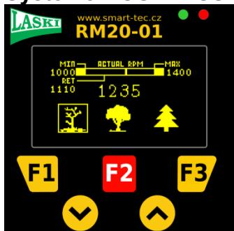
Le dispositif sert d'une protection contre la surcharge du moteur à combustion. Il consiste à une unité électronique de commande et à un lecteur de tours, installé près de l'arbre de rotor.
