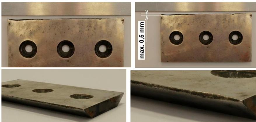
Utilisé le couteau d'un côté, inégalement. Max. usure (perte de matière) peut atteindre le 0,5 mm, la plus grande que la perte se produit n'est plus dans la formation des rayons non désirés sur la lame et la formation des chocs pendant le plus de burinage
