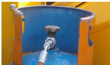
Soupape d'arrêt des bouteilles de gaz à pression.
