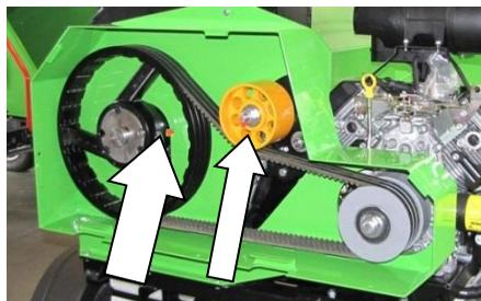
Graisseur du palier du disque broyeur et
