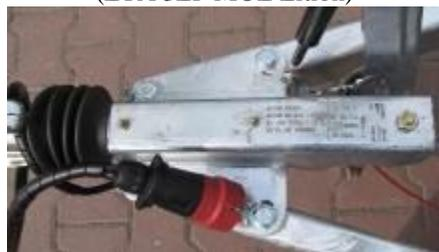
Graisseur sur le timon du châssis
