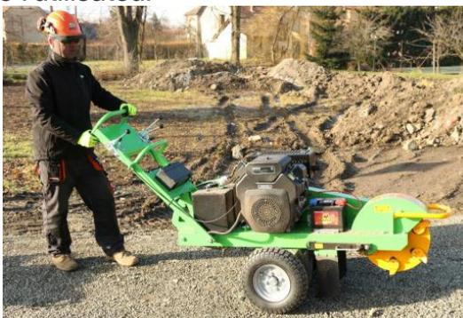
Pendant le travail, l'utilisateur doit se placer derrière la machine (voir photo), tenir le guidon avec les 2 mains et se tenir debout sur un sol plat. Tous les mouvements de travaux doivent être souples et continus.
