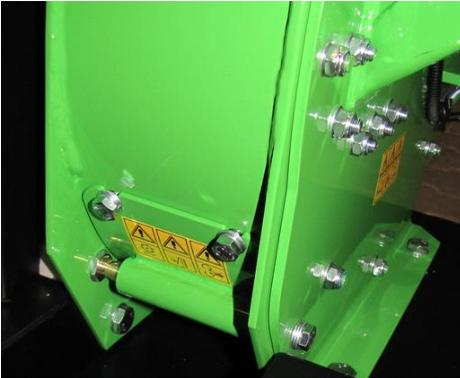
Accès pour les couteaux à découper, à l'espace de broyage permet de couvrir, qui est fixée par deux vis et interrupteur de sécurité sécurisé.
