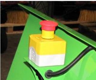
Le bouton d'urgence du débranchement de la goulotte de remplissage permet instantanément d'éteindre le moteur en marche. Attention rotor continue à tourner.
