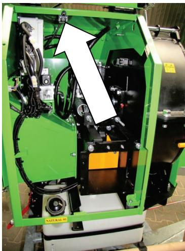
**Le bouton d'arrêt d'urgence** - après avoir appuyé sur le bouton, le moteur à combustion et toute la machine s'arrêtent.
