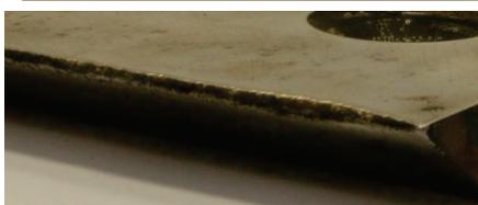
Utilisé le couteau d'un côté, inégalement. Max. usure (perte de matière) peut atteindre le 0,5 mm, la plus grande que la perte se produit n'est plus dans la formation des rayons non désirés sur la lame et la formation des chocs pendant le plus de burinage
