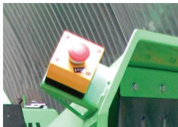
**Bouton d'arrêt d'urgence – permet de couper le moteur pour piloter les machines**
