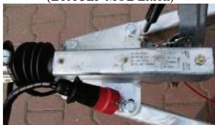
Graisseur sur le timon du châssis
