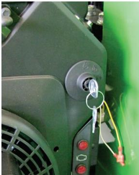
**La boîte de contrôle assure l'alimentation et la commande du circuit de sécurité et du moteur à combustion.**
