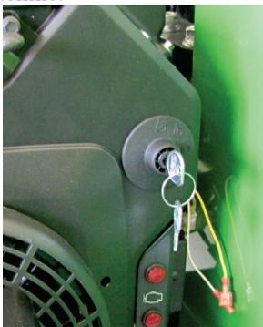
**La boîte de contrôle** est munie d'une clé amovible. Une substitution des clés est exclue. Le démarrage du moteur est possible en tournant la clé à la position START. La marche du moteur continue à la position RUN. La boîte ne permet pas de redémarrer de la position RUN; il faut remettre la clé à la position initiale OFF.
