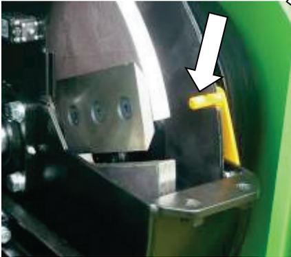
Le pivot de blocage du rotor du dispositif broyeur sert à arrêter le moteur pendant un entretien ou un remplacement de lames etc. Le pivot est oscillant, fixé sur la boîte du rotor. Pour bloquer le rotor, il faut déplacer le pivot dans une rainure sur le périmètre du cylindre.
