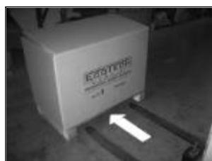
Figure 4-1 : Emballage avec indication du point/de la direction de levage
