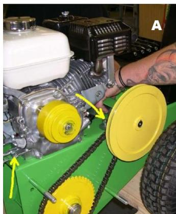
**Pas-1:** Dégager les vis de l'arbre de renvoi et du moteur – dégager la chaîne motrice - *fig. A*
