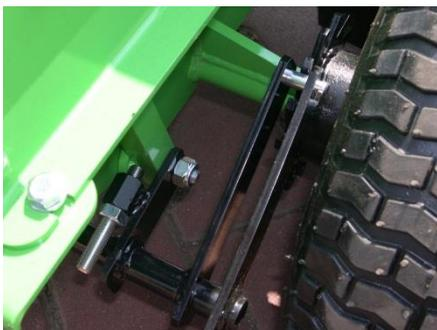
Vue d'une roue bloquée par le cliquet à la position du levier "Creusé min. à max."
