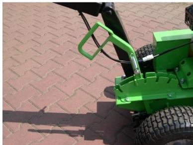
Levier de creusage en position "Creusé min."
