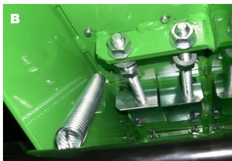
**Pas-2:** Par les tendeurs sur le dessous du châssis (*fig.B*) tendre la chaîne. En même temps il faut veiller à ce que la poulie du renvoi soit parallèle à la poulie du moteur. Chaque palier du renvoi a son propre
