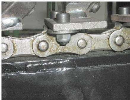
fixage de l'entraîneur sur la chaîne
